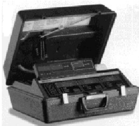
Figura 21. Analizador Electroquímico de Gases de Combustión
