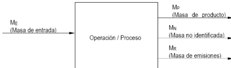
Figura 2. Esquema de las corrientes involucradas en el Balance de Masas
