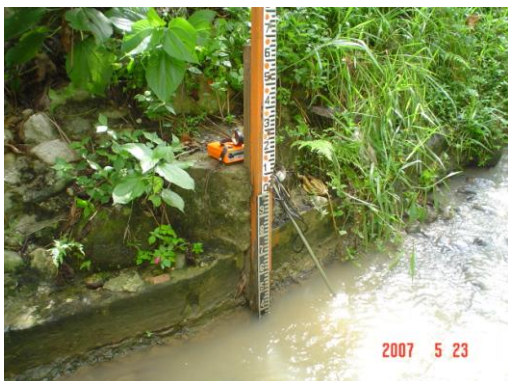
Limnómetro anclado sobre muro de concreto
