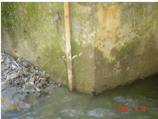
El Limnómetro estaba anclado a la aleta del puente
