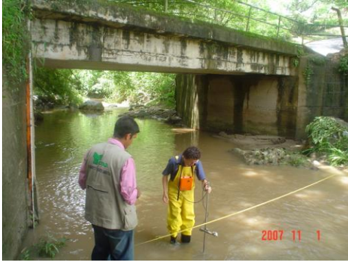
Realizando el aforo
