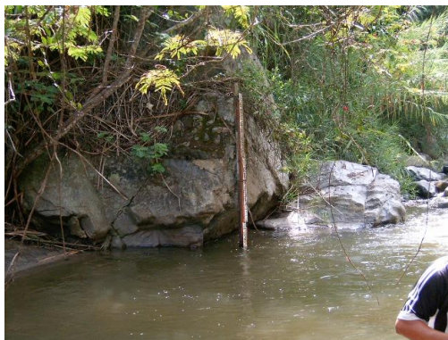
Limnómetro anclado sobre una piedra
