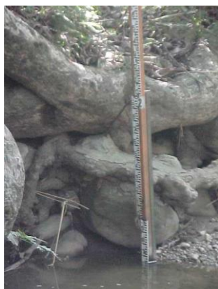
Limnimetro anclado sobre piedra
