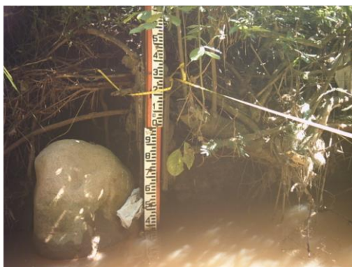
Limnmetro anclado a una piedra
